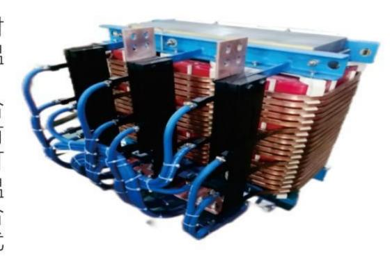
公司研发的稀有合金高温炉专用水冷变压器整机容量2150kVA的变压器分为14个安装单元,分别布置到炉体顶面和侧面,整机安装高度达到4.5米,对抗震结构提出了很高的要求。为了保证高温炉的调温要求,水冷变压器要具备原边大范围调压功能,经过精确的电气参数设计计算和科学的结构设计,在保证产品的电气性能优良的前提下,高压线圈采用自冷箔式结构,低压线圈采用水冷铜管式结构,整体线圈为同心式分布轴向压装,既降低了器身高度,且保证高效的散热。
